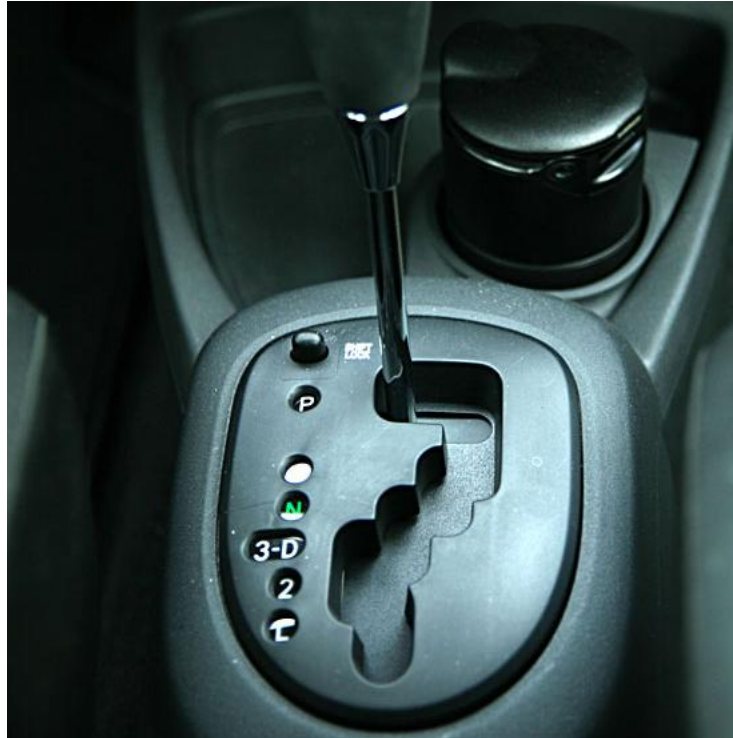
Hình 2.14: Điều khiển cần số hộp số tự động
