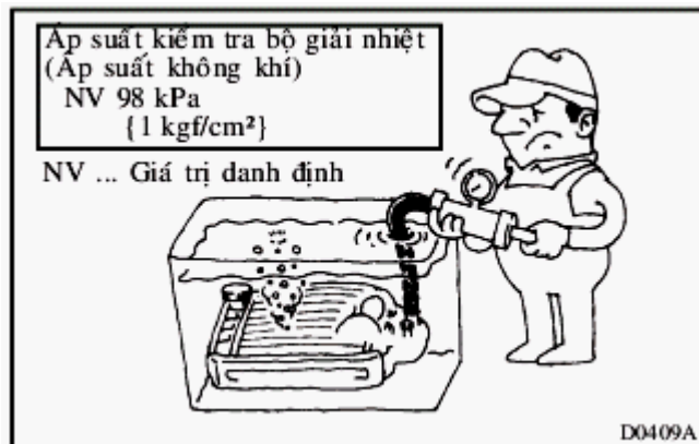
Hình 6.10. Kiểm tra nắp bộ giải nhiệt kết nước
