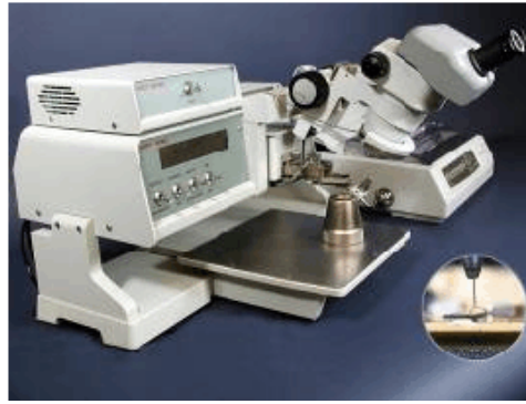
Hình 1.8 Kiểm tra mối hàn bằng phương pháp kéo
