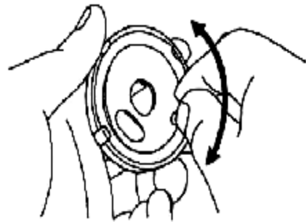
Hình 6.12 Kiểm tra mâm chia điện.
