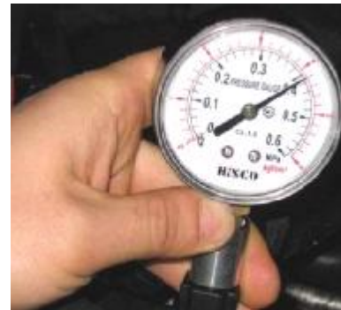
Hình 5.9. Đo áp suất nhiên liệu.
