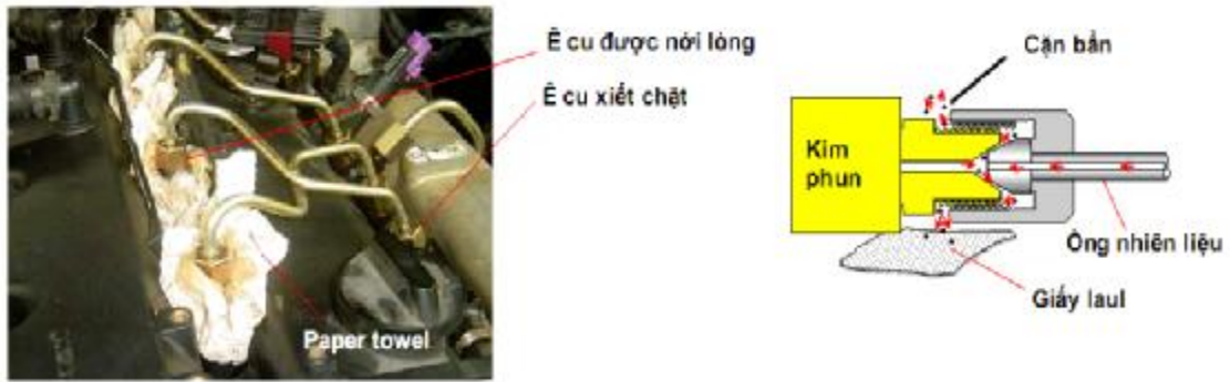
Hình 5.20. Xả nhiên liệu và cặn bẩn ra khỏi ống cao áp và vòi phun.
