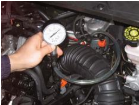
Hình 5.9. Đo áp suất nhiên liệu.
