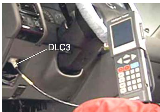
Hình 4.43. Đọc mã lỗi bằng thiết bị.
