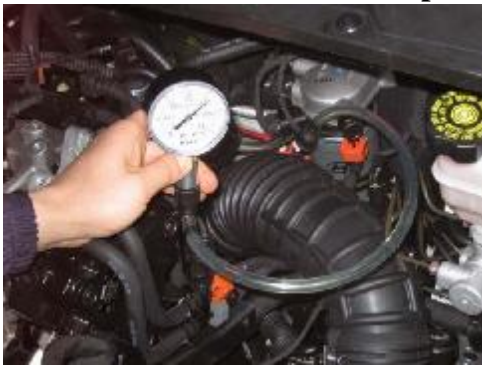
Hình 5.9. Đo áp suất nhiên liệu.
