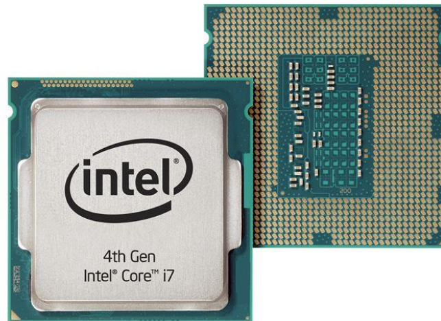
Hình 1.. CPU Intel Core i7, thế hệ 4
